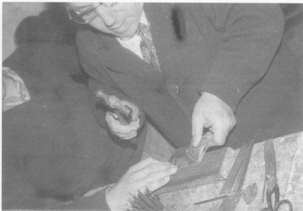
Embutición de la lámina de plata sobre el molde de acero cincelado
